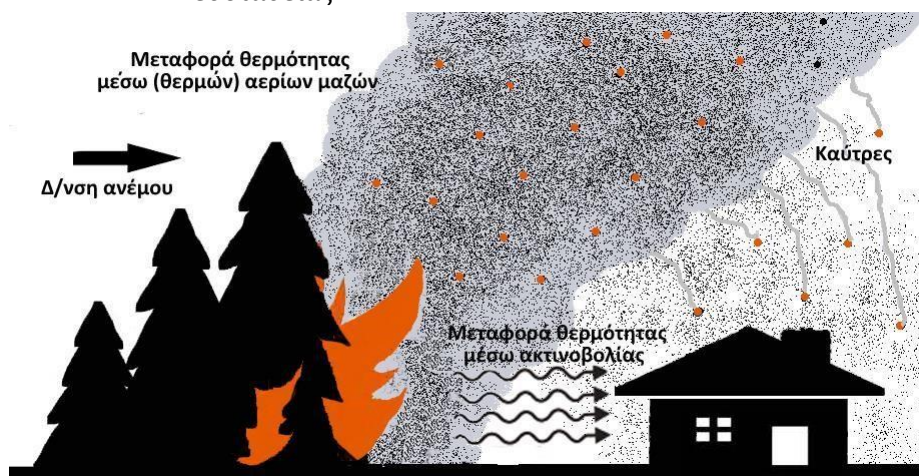
Σχέδιο 2. Τρόποι ροής της θερμότητας σε μια δασική πυρκαγιά, που εξελίσσεται πλησίον κτιρίου και απεικόνιση πιθανού τρόπου μετάδοσης δασικής πυρκαγιάς με μεταφερόμενες καύτρες σε κτίρια χωρίς την παρουσία ανέμου υπό συνθήκες πρόσκαιρης νηνεμίας, ή ατμοσφαιρικής ευστάθειας
