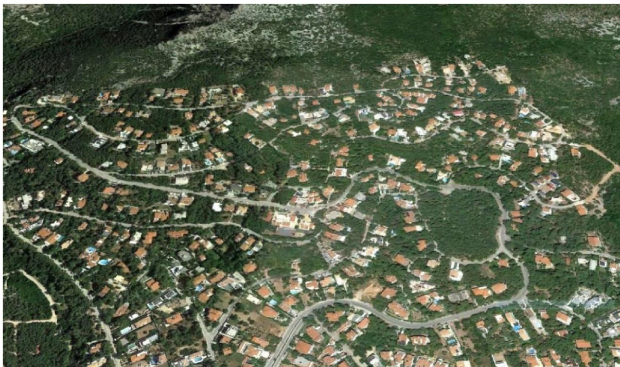
Εικόνα 7.2: Δομημένη περιοχή που κατά το παρελθόν έχει αναπτυχθεί εντός δάσους ή δασικής έκτασης και τα κτίσματα που την συγκροτούν έχουν μεγάλη εγγύτητα με καύσιμα δασικής προέλευσης.
